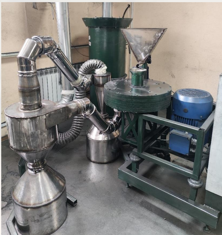
Фотография пилотной установки для получения сферического графита
